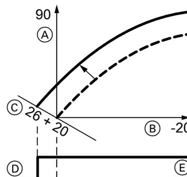
Fig. 59 Exemple 1 : modification de la consigne de température ambiante de 20 à 26 °C
