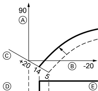
Fig. 60 Exemple 2 : modification de la consigne de température ambiante réduite de 5 °C à 14 °C
